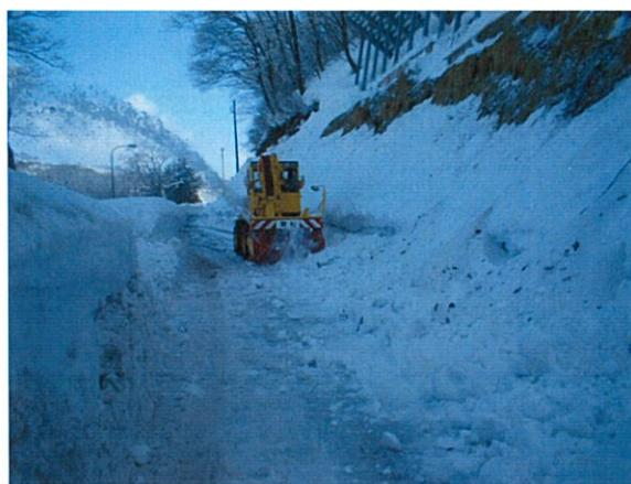
【除雪の手順②】タイヤドーザにより道路片側に寄せられた雪をロータリー除雪車で排雪箇所へ投雪します。雪が民家や人に当たらないよう、細心の注意を払って作業を行います。
