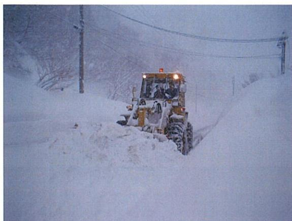
【除雪の手順①】タイヤドーザで道路に積もった雪を片側に寄せていきます。効率よく雪を寄せるためには、排土板（車体前方の雪を押す鉄の板）の高さや角度の絶妙な操作が必要です。
