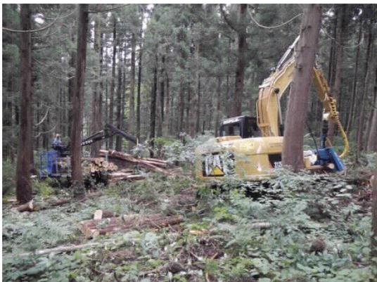
【写真】 高性能林業機械による搬出間伐
