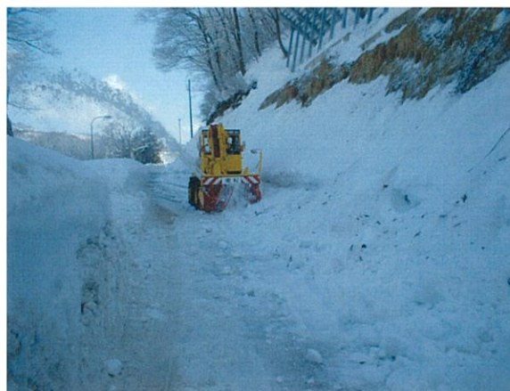
【除雪の手順②】タイヤドーザにより道路片側に寄せられた雪をロータリー除雪車で排雪箇所に投雪します。雪が民家や人に当たらないよう、細心の注意を払って作業を行います。
